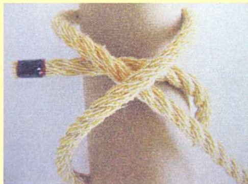
⑧ロープの先端を⑥でできている交差部分の下に通して引っ張れば、⑤と同じになります。
